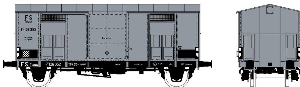
Una particolare versione del carro F Tipo 1937 costruita sperimentalmente in profilati e lamiere di alluminio.
